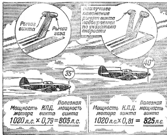
Рис. 20. Повышение максимальной скорости на высотах, меньше расчетной, за счет понижения числа оборотов рычагом винта.
